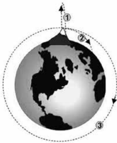
Figura 1. Si tirem una pedra cap amunt a la velocitat suficient, arribarà a l'espai però tornarà a caure (1). Si la tirem cap avant a la velocitat necessària, uns 28.200 km/h, es posarà en òrbita (3).
